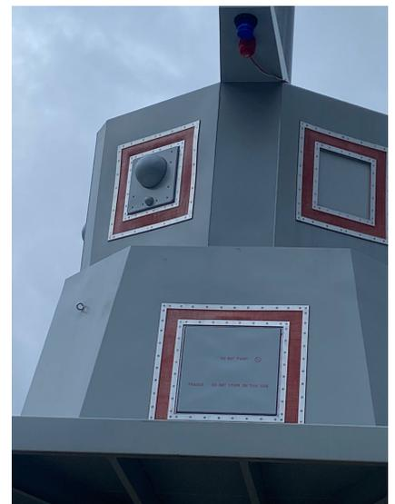
Sullo Shelter, attraverso idonee interfacce meccaniche / elettriche, è posizionata una struttura metallica per gli alloggiamenti di Antenne, sistemata sul tetto del container e realizzata in nr.3 sezioni singole amovibili, ognuna dotata di interfacce per il sollevamento di ognuna di esse.
